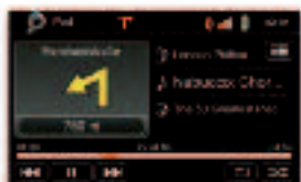
New SplitScreen Der automatische CAN-Bus-Adapter des Z-E2014M ermöglicht die Anzeige von Bluetooth- und Audio-Informationen auf dem Touchscreen.
