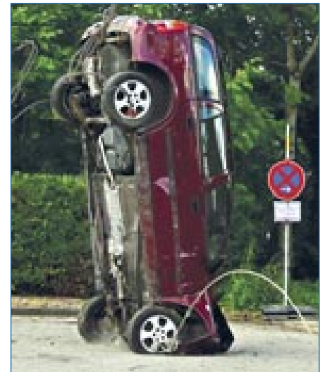
Das Schrottauto wurde in 22 Metern Höhe ausgeklint, das entspricht einem Aufprall mit gut 50 Stundenkilometern.
