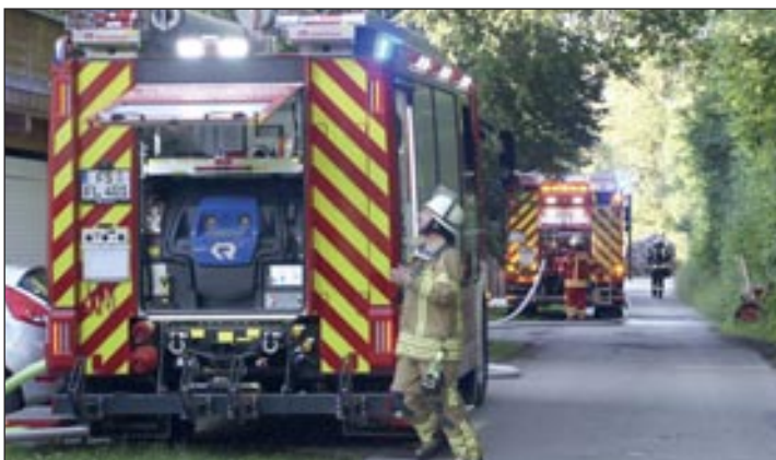
Zügig wurde mit Schnellangriff und später vom Hydranten aus eine stabile Wasserversorgung aufgebaut
