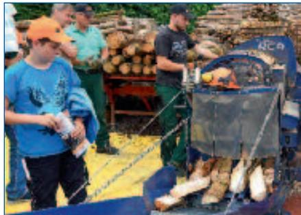
Die Maschine der Firma Weber spaltet und transportiert Holzstämme in einen Drahtkorb.
