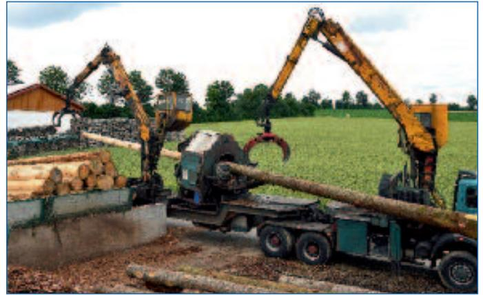
Entrinden im Akkord: Ein Kran hebt Stämme bis 60 Zentimeter Durchmesser in das Gehäuse mit den rotierenden Messern, der zweite nimmt das entrindete Holz und legt es wie spielerisch ins Depot.
