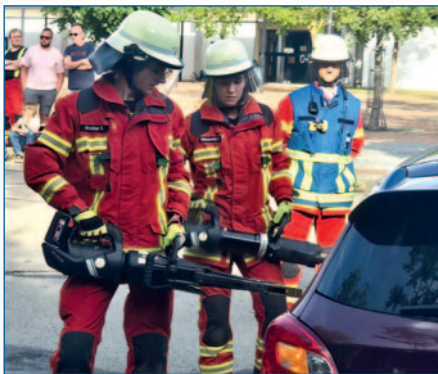
Mit Rettungsspreizer und -schere verschafften sich die Einsatzkräfte Zugang zur »verletzten Person« im Unfallauto.
